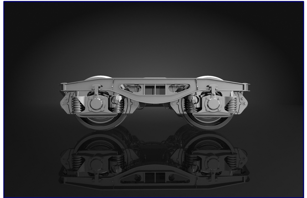
Fahrwerk Y25 LS1-K (für Güterwagen mit einer Achslast von 22,5 t)
